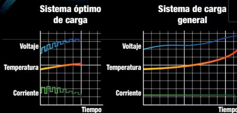
El cargador rápido de Makita se comunica con el chip incorporado de la batería durante todo el proceso de carga para optimizar la vida útil de la batería controlando activamente la corriente, el voltaje y la temperatura.
