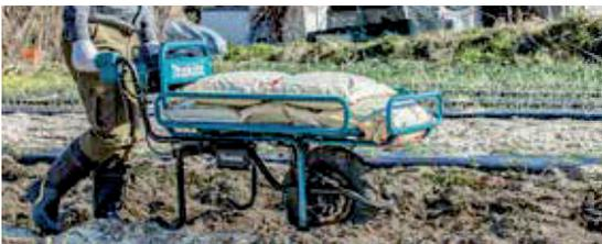
Después de quitar las ruedas traseras y las patas de soporte instaladas (equipo estándar), el carro se puede usar como monociclo, especialmente conveniente para carreteras en mal estado.
